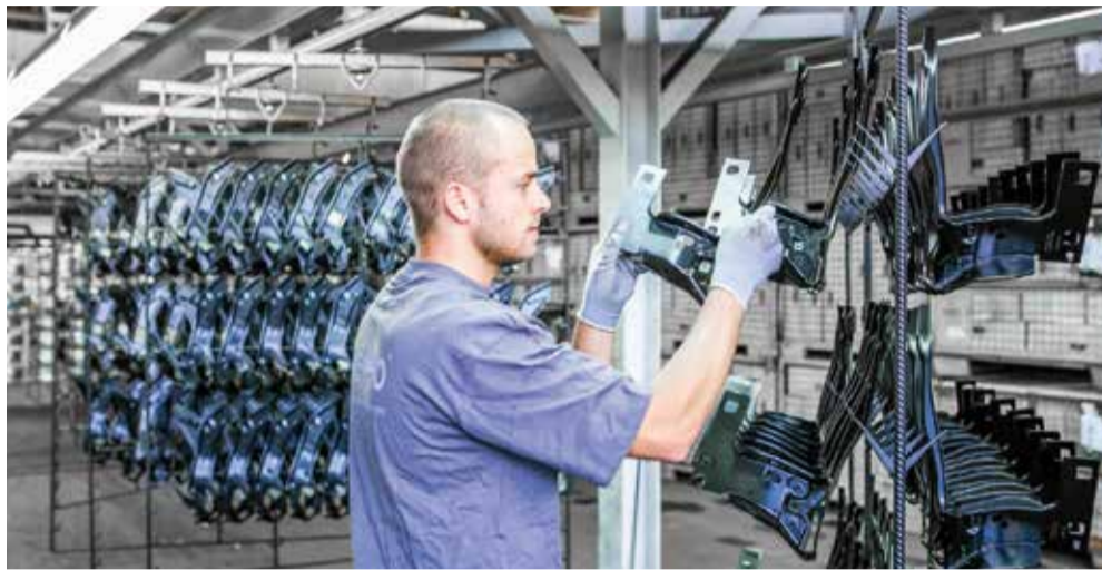
Die Vorder- und Rückseite der Führungsschienen müssen nahezu gleich Schichtdicken aufweisen, sonst klemmt später das Autofenster.
