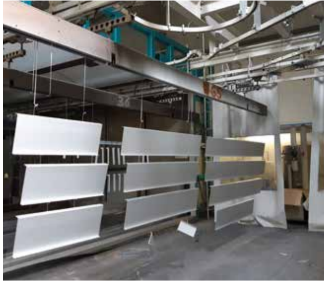
Serienprodukte beschichtet die GSO in der automatischen Durchlaufanlage mit Pulverrückgewinnung.
