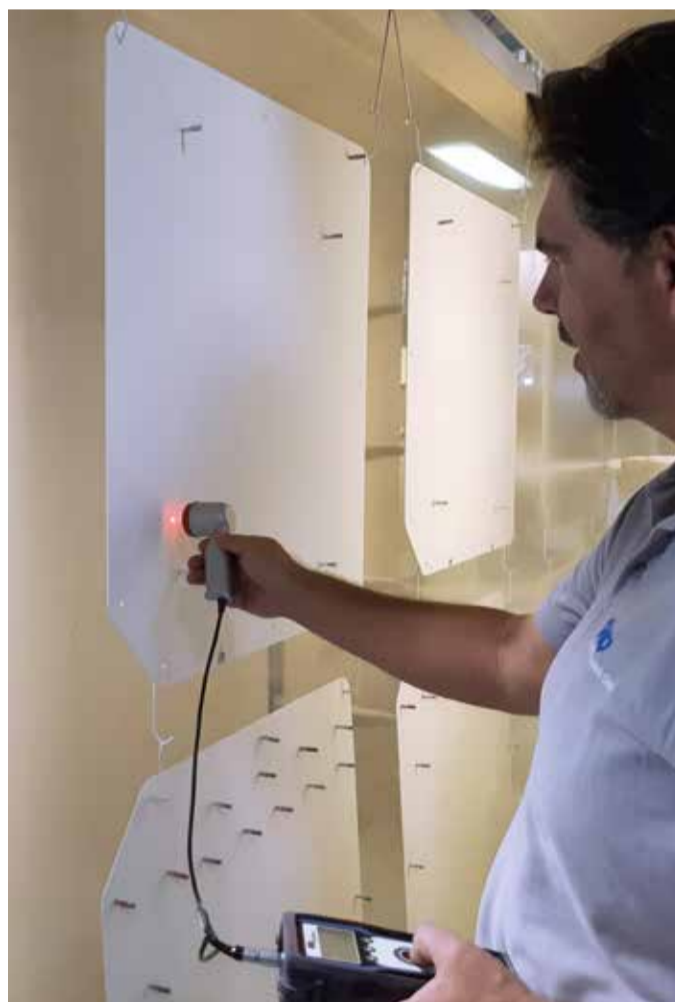
GSO-Geschäftsführer Horst Schuller prüft die Schichtdicke mit dem „PaintChecker“.
