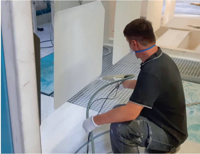
Einzel- und Musterteile pulvert der Lohnbeschichter aufgrund der vielen Farbwechsel in der Kleinteilekabine manuell.
