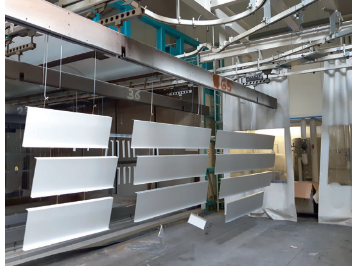
Serienprodukte beschichtet die GSO in der automatischen Durchlaufanlage mit Pulverrückgewinnung.
