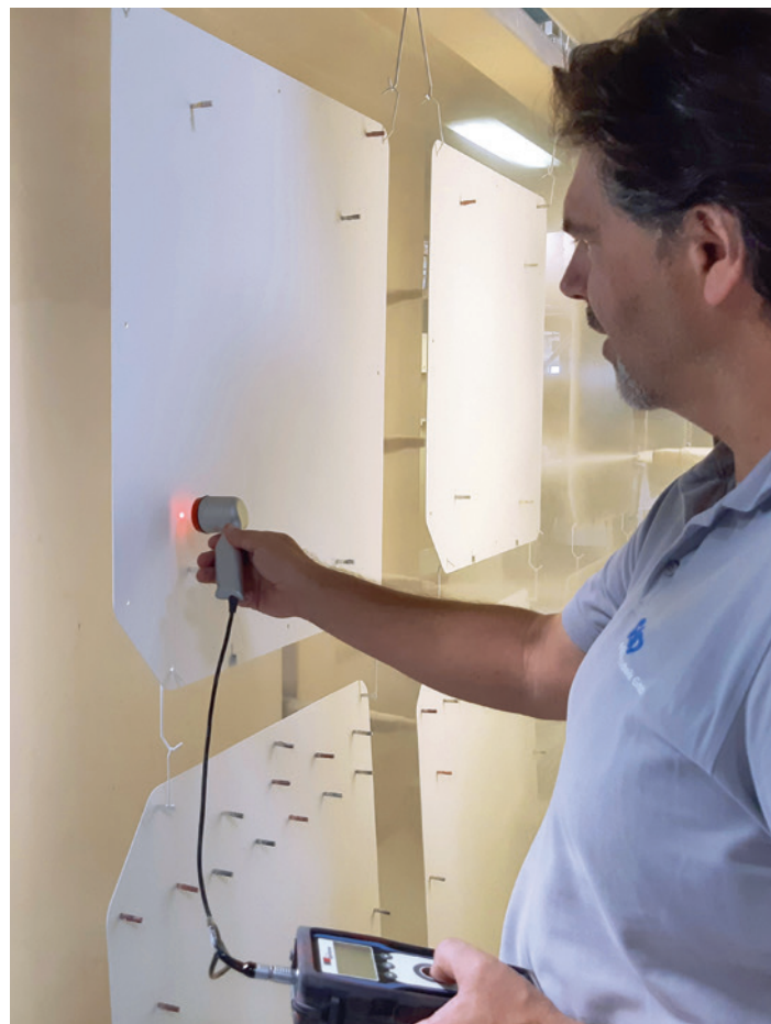
GSO-Geschäftsführer Horst Schuller prüft die Schichtdicke mit dem „PaintChecker“.
