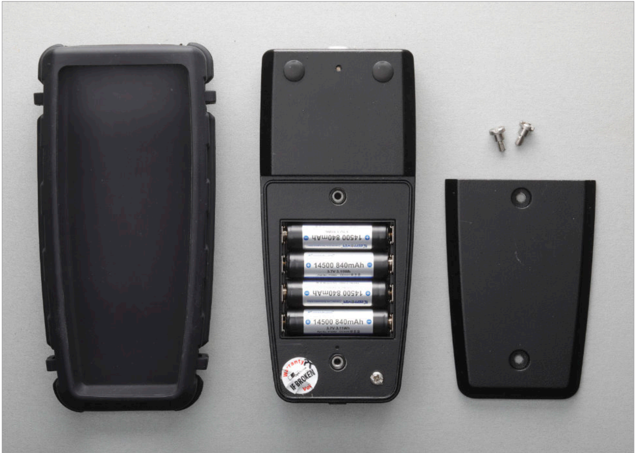
Las baterías se colocan en la parte posterior del PaintChecker Mobile
